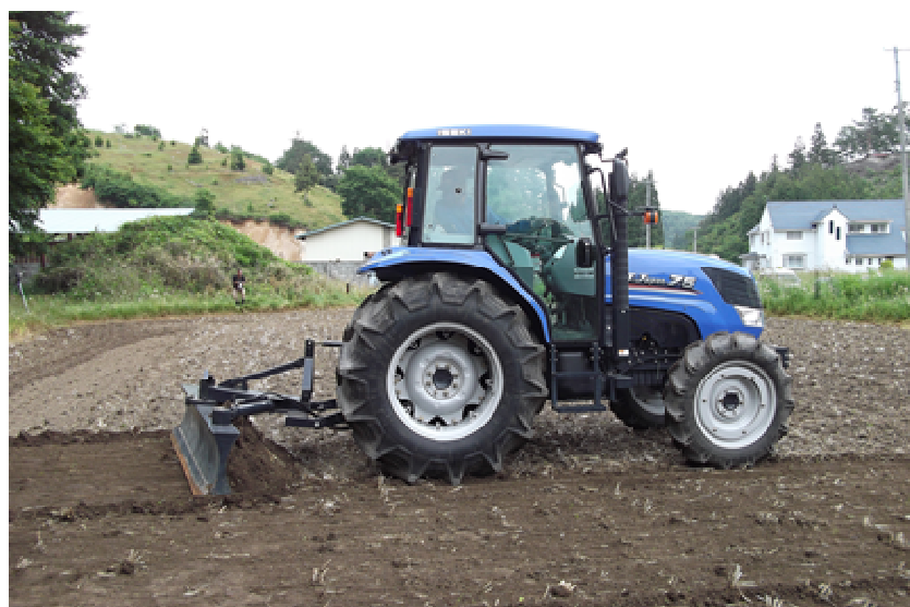
図 2-54 農機による農地の削り取りの例
